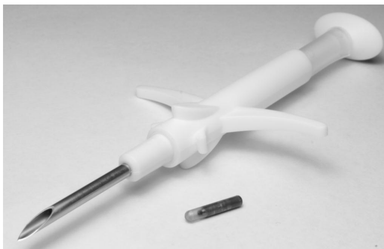
Рисунок 1 – Инъекционный микрочип в капсуле для идентификации лошадей (заправляется в одноразовый стерильный шприц)
